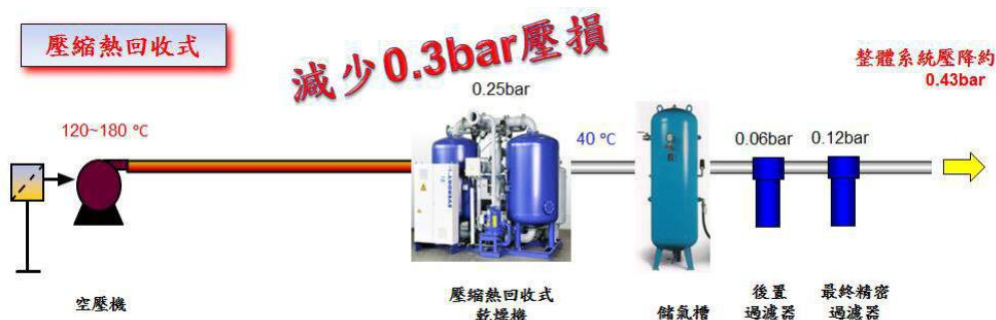
圖 2 零耗氣-70°C 壓縮熱回收式乾燥機之系統配置
