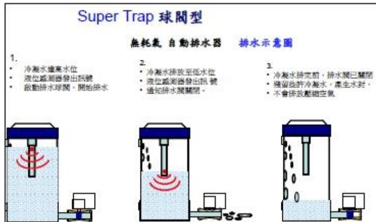
圖 6 球閥型無耗氣自動排水器動作
