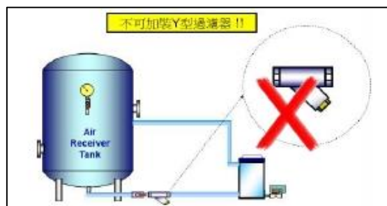
圖 9 無耗氣自動排水器不可加裝 Y 型過濾器
